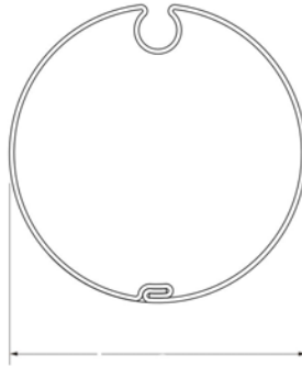
Falleiste rund Tuchwelle 70 / 78 mm 42 mm
